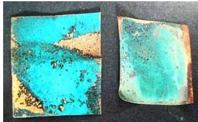
Abb.2 Grünspan auf einer Kupferoberfläche
