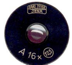
Abb. 5. Okular mit der Lupenvergrößerung 16x, der Sehfeldzahl von 12,5 mm und die Bezeichnung A für ein nicht-kompensierendes Okular.
