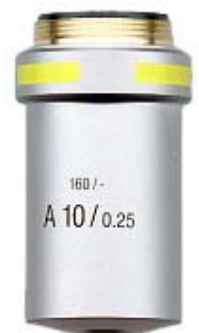
Abb. 7. Folgende Bedeutungen tragen die Kürzel auf der Fassung: • Tubuslänge (160 mm) • Deckglasdicke (-) • Objektiv ohne chromatische Abbildungsdifferenz (A) • Maßstabszahl (10) • numerische Apertur (0,25)
