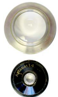
Abb. 8. Zweilinsiger aplanatischer Kondensator.
